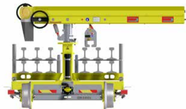
Схема за товарене с макс. 12 броя релси на два етажа
